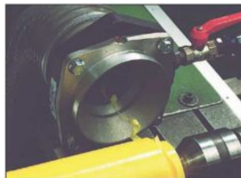
циркулярный Transvector эффективно удаляет отходы и шлак
