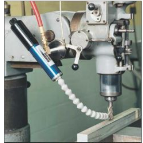
Используйте Модель 610 Регулируемая холодного воздуха сопло увеличивает скорость подачи
