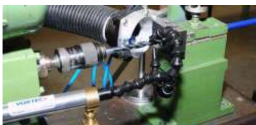
Охлаждение металлообработок с одновременным удалением стружек
