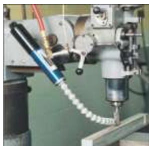
Охлаждение фрез, сверл
